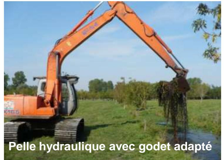
Pelle hydraulique avec godet adapté
